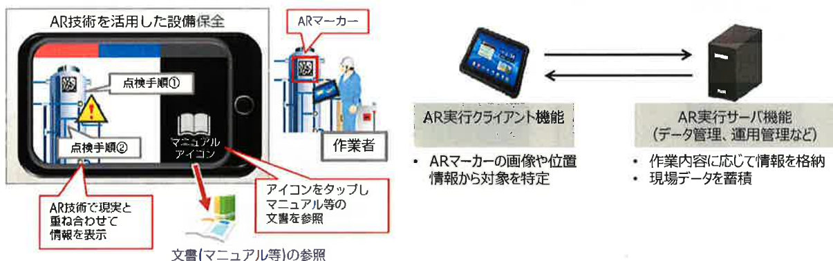
設備保全でのAR活用例
