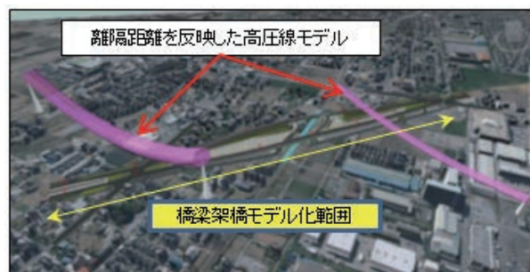
図6 電線との離隔確認
