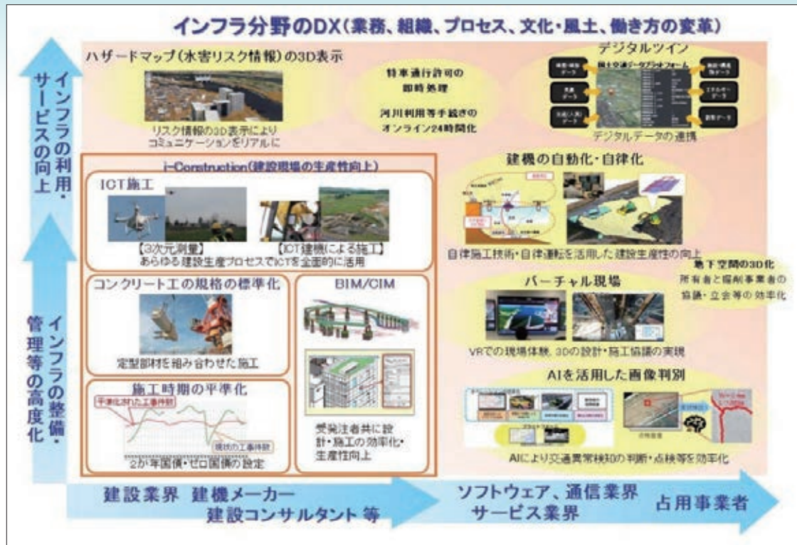
図1 i-Constructionとインフラ分野のDXの関係
