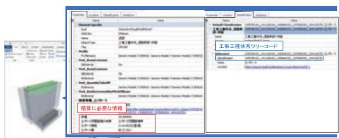
図7 積算に必要な属性情報を設定した例
