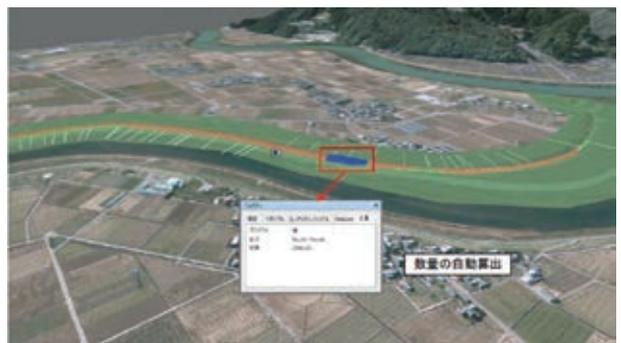
図5 推奨項目の例(盛土の数量算出)
