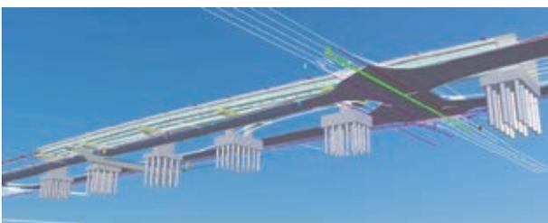
図3 義務項目の例(特定部(杭、地下道、埋設物)の確認)
