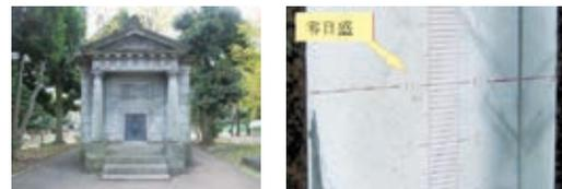
写真1(左:日本水準原点標庫、右:水晶板の零目盛)
